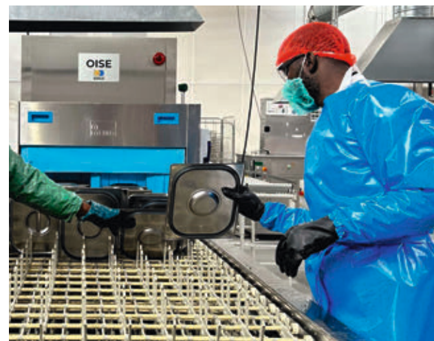
Sur la base de son expérience et fort de son partenariat avec la société Meiko, Uzaje a implanté un tunnel de lavage de 23 mètres.
